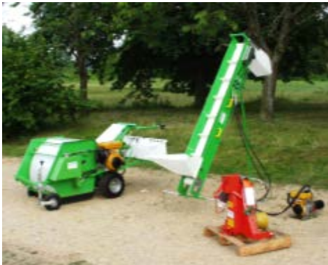
Handgeführte Sammelmachine mit Lade-förderband und Seilschüttler (rechts)
