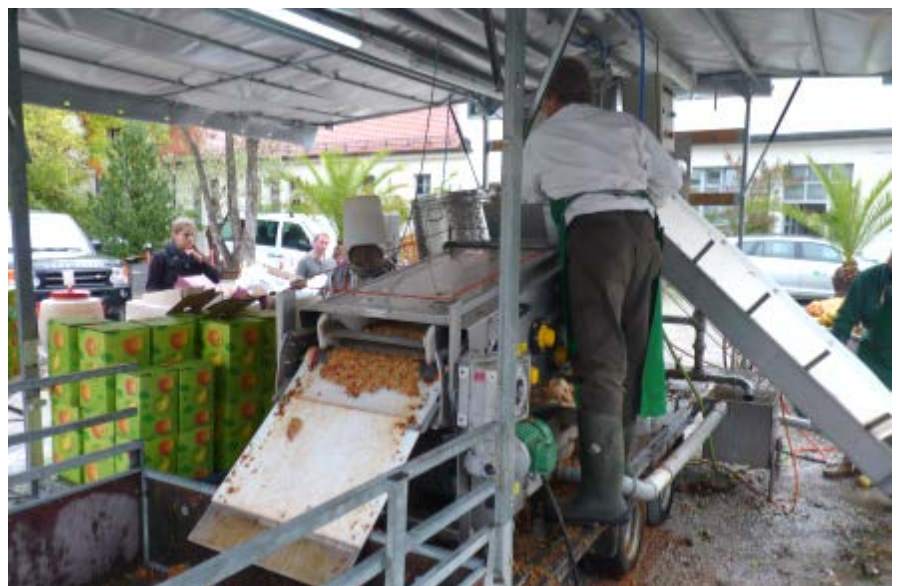
Mobile Saftpresse für eigenen Saft aus eigenen Äpfeln („bag in box“)
