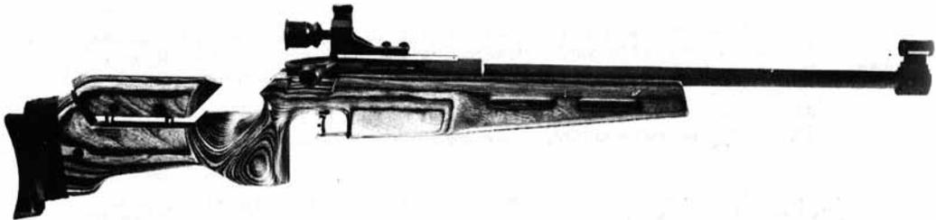
Wurde aus dem Steyr Mannlicher MATCH-UIT entwickelt. Die Waffe ist ein Einzellader ohne Magazin. Neu gestalteter Schichtholzschaft mit Schiene im Vorderschaft zur Montage des Handstops. Steyr Präzisionsdiopter und Kornhalter. Über dem 600 mm langen Lauf ist ein Flimmerband montiert. Kombischiene für Gehäuse, welche die Montage eines Zielfernrohres ermöglicht, ist auf Wunsch lieferbar.
