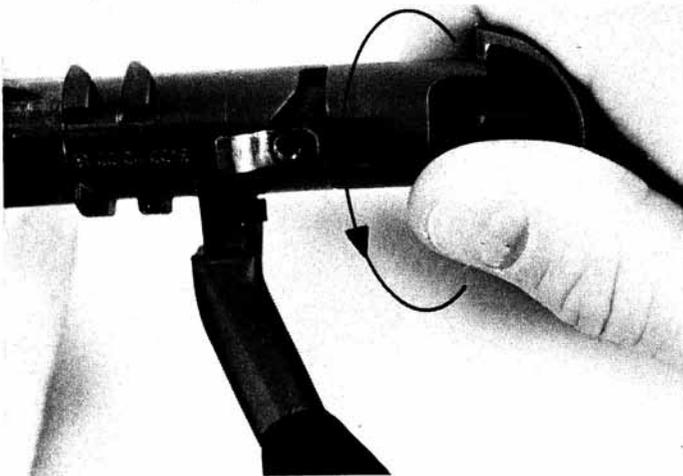
6. Der Schlagstift läßt sich nunmehr herausziehen und der Kammergriff von der Kammer abziehen. Ebenso läßt sich die Stützhülse vom Schlagstift abziehen. Nunmehr können bei Bedarf alle Teile gereinigt werden.
