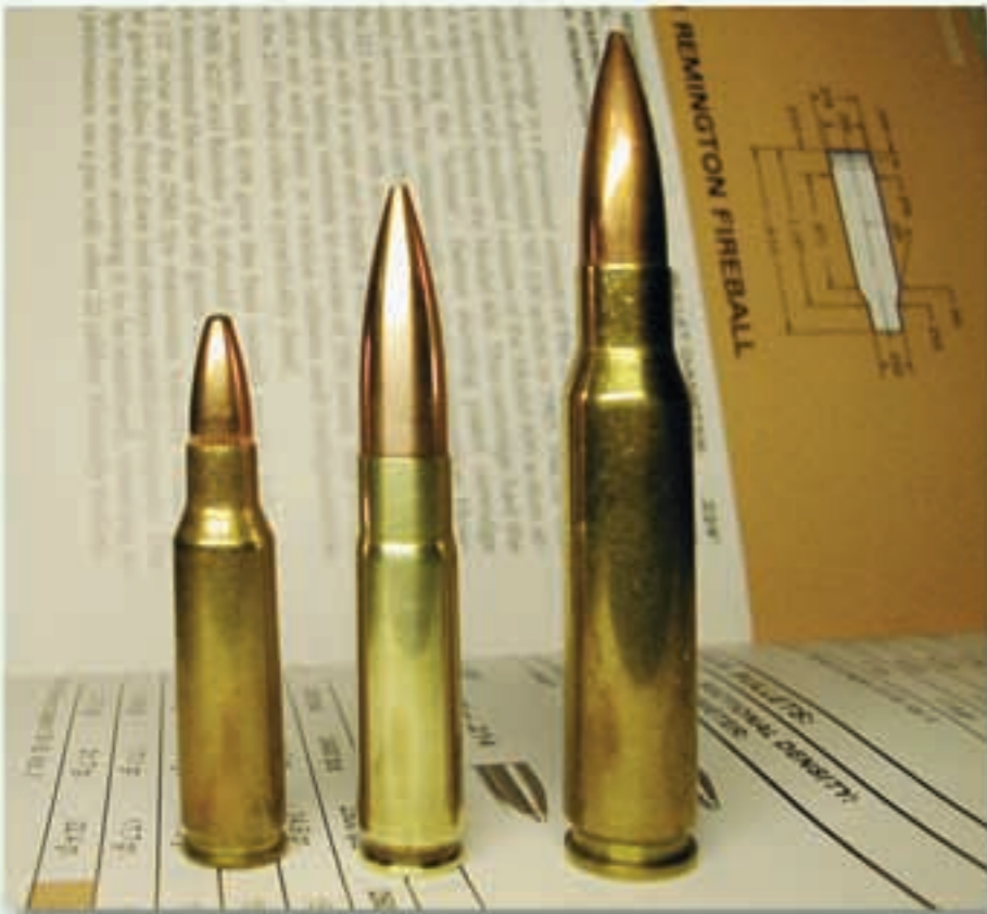
Leisetreter mit Leistungspotential. Die .300 Whisper (mitte) basiert auf der Hülse der .221 Remington Fireball (links) und verwendet Geschosse im Durchmesser .308", wie die .308 Winchester (rechts),
