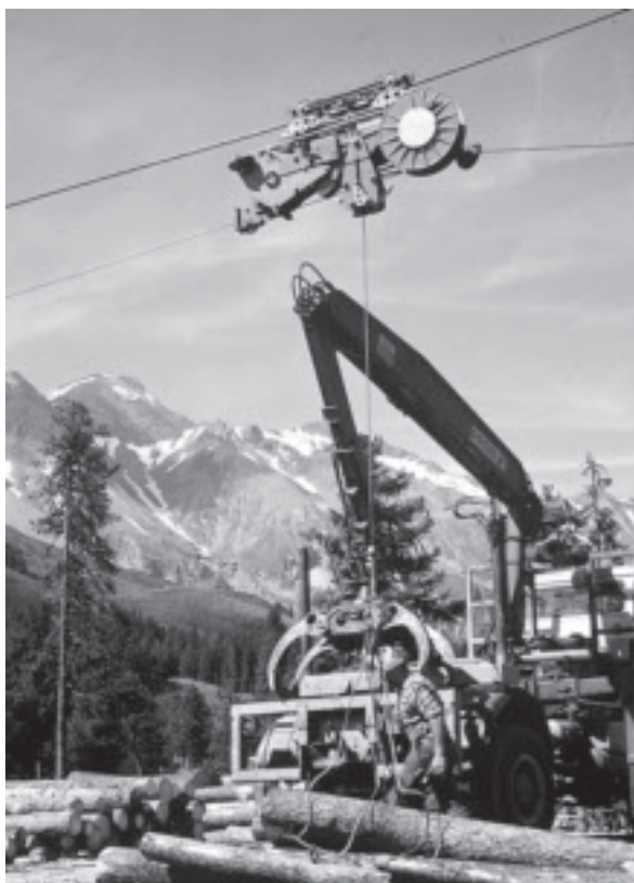
Holzbringung mit Seilkran
