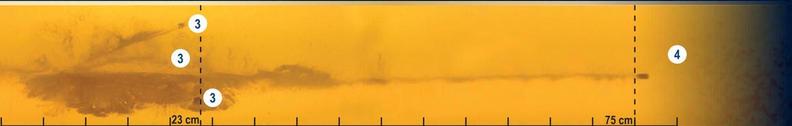
Gelatine-Beschuss mit dem KSB Geschoss aus einer Distanz von 100 Metern.
