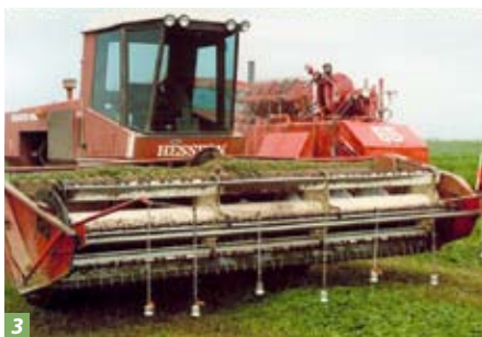
An Traktoren bzw. selbstfahrenden Heu-erntern montierte Aufscheuchgestänge mit großer Wirkung Fotos aus Green 2007
