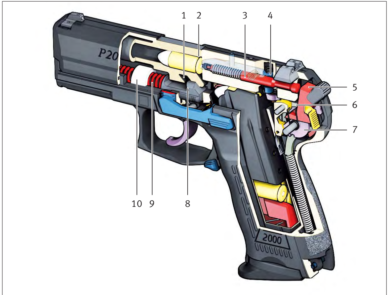
Abb. 13a: Abzugsvariante CDA, Schnittdarstellung
