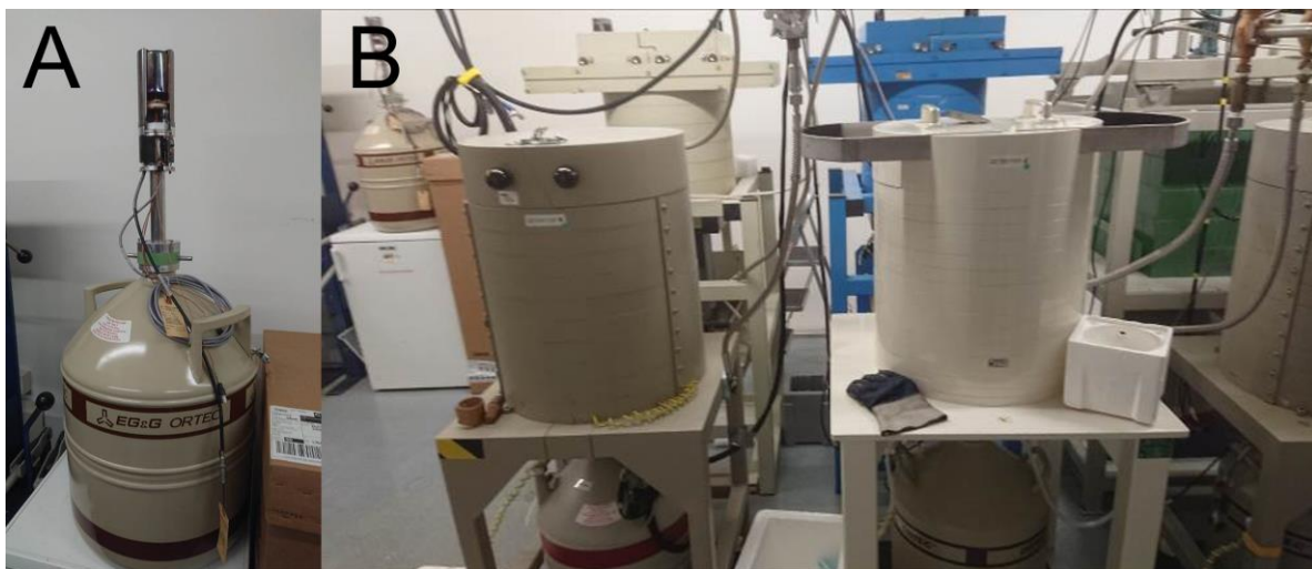
Abbildung 5 A und B: Gammaspektrometer der Firma Mirion Technologies (Canberra) GmbH
