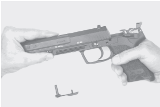
Verschluss abziehen Remove the slide
